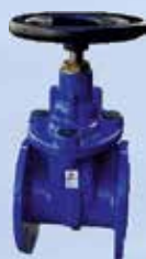
Keilflachschieber - PN10/16/25 innenl. Spindel - weichdichtend EPDM/NBR Material: GJS-500-7 - EKB-beschichtet Fig.800, 801, 804
